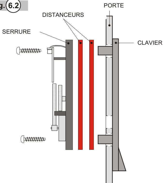
Pour des portes avec une épaisseur réduite, il est possible d'utiliser plusieurs distanceurs.
