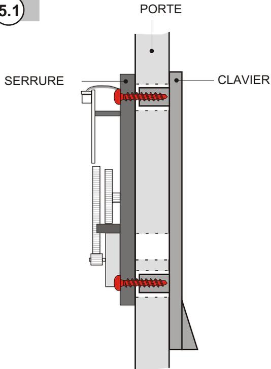
Fixer la serrure et le clavier à la porte au moyen des 4 vis pour plastique avec tête cylindrique diamètre **4 mm**, longueur **20 mm**.
